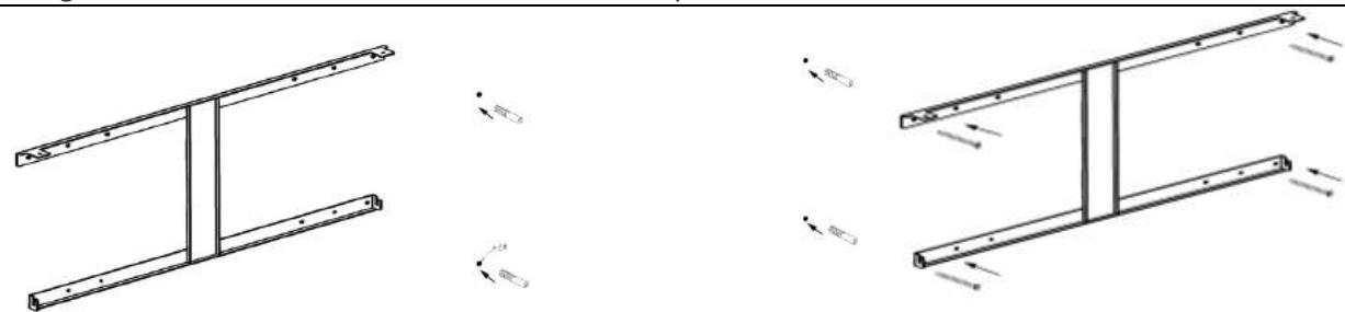
**STAP 2.** Kies een stevige en vlakke muur en plaats de montagebeugel op de gewenste positie. Markeer met een pen de 4 bevestigingsgaatjes van de beugel op de muur.
