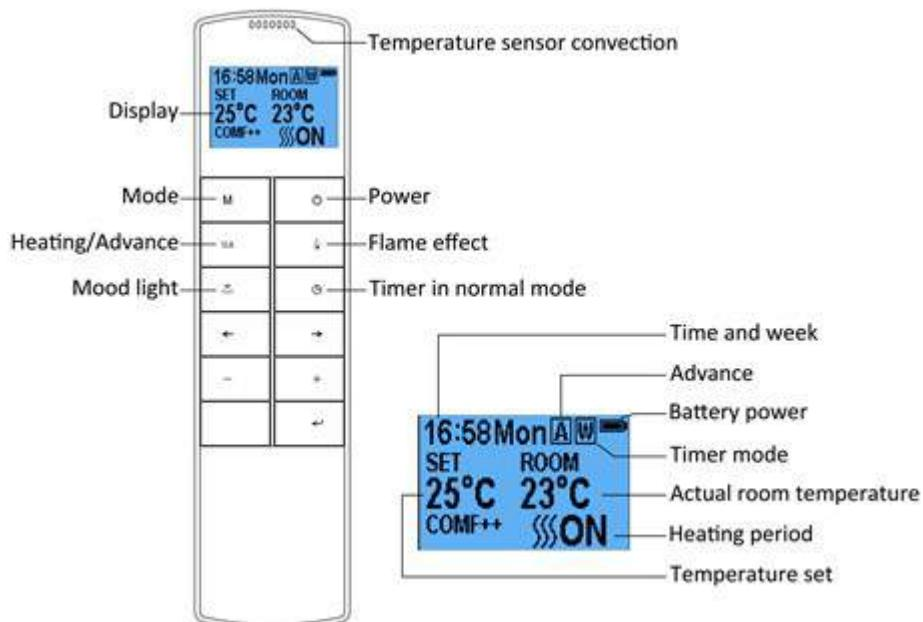
**Important ! Il s'agit d'une télécommande avec thermostat. La télécommande doit se trouver à tout moment dans la pièce où se situe le poêle et elle doit être placée sur une surface plane.**
