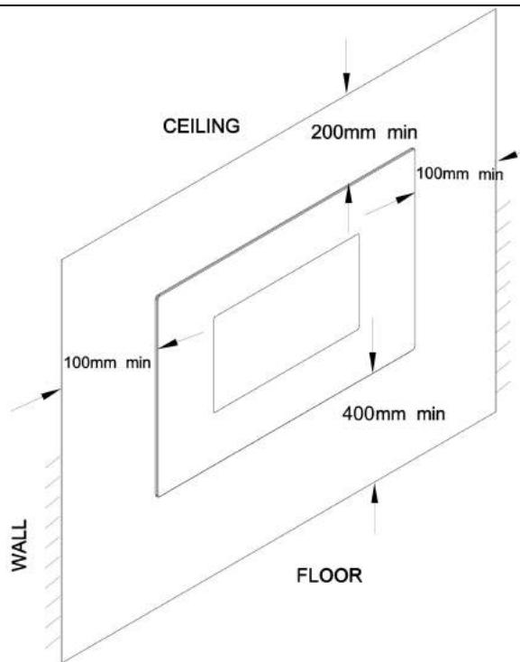
**ÉTAPE 1.** Trouvez un endroit sûr. Distance minimale de chaque côté doit être d'au moins 100 mm; distance minimale par rapport au sol doit être d'au moins 66mm; dégagement minimal de l'avant doit être d'au moins 3 pieds (100 cm). Choisissez un emplacement près d'une prise pour une rallonge n'est pas nécessaire. Ne pas placer l'appareil directement sous une prise de courant.
