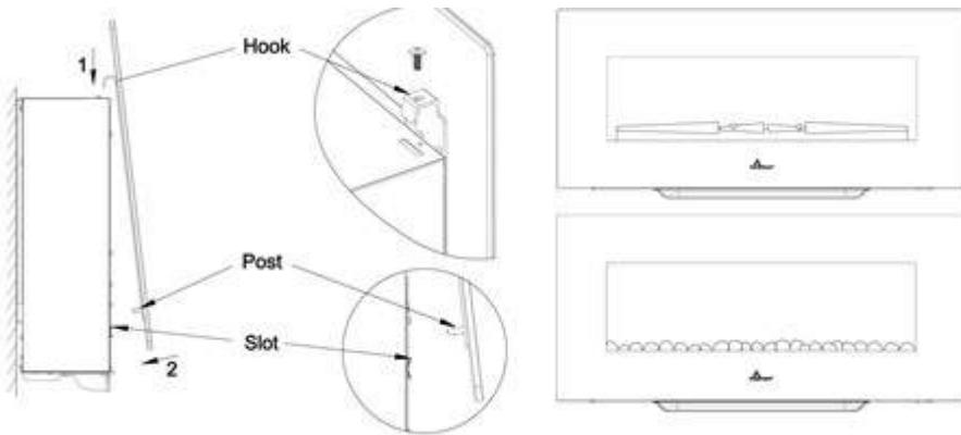
**SCHRITT 6.** Vorsichtig setzen Sie beide Haken der Frontscheibe in die Schlitze an der oberen Vorderkante der Feuerraum. 2. Drücken Sie die beiden Beiträge der Glasplatte in die Verriegelungsschlitz in der Nähe der unteren Ecken des vorderen Feuerraum Panel. **HINWEIS:** Stellen Sie sicher, dass die Beiträge in die Schlitze auf.
