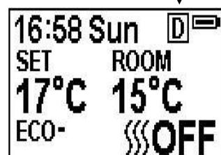
3.2.17 Drücken Sie auf die **M** bis **D** Taste in der oberen rechten Ecke des Displays. Danach gelangen Sie in das Menü der täglichen Timer-Funktion.
