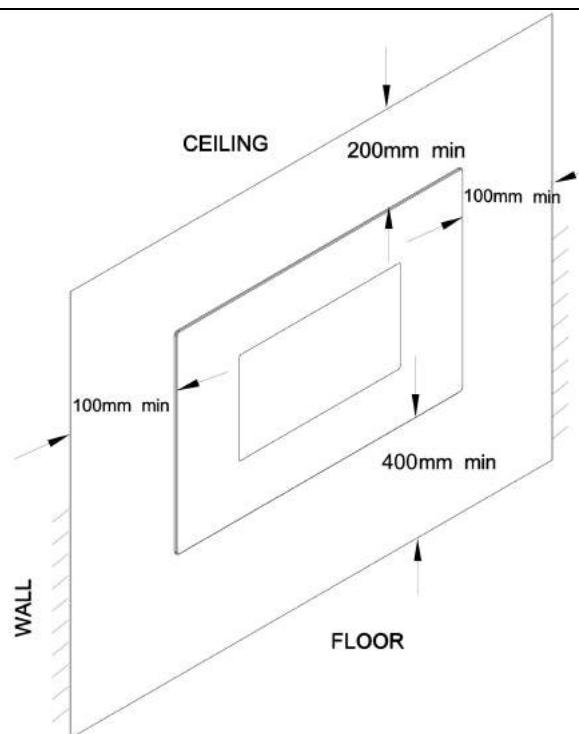
**STAP 1.** Zoek een veilige locatie. Minimale vrije ruimte aan elke kant moet ten minste 100 mm zijn; minimale afstand van de vloer moet minimaal 400mm zijn; minimale afstand van de voorkant moet minimaal 100 cm zijn. Kies een locatie in de buurt van een stopcontact zodat een verlengsnoer niet nodig is. Gebruik de haard niet direct onder een stopcontact.
