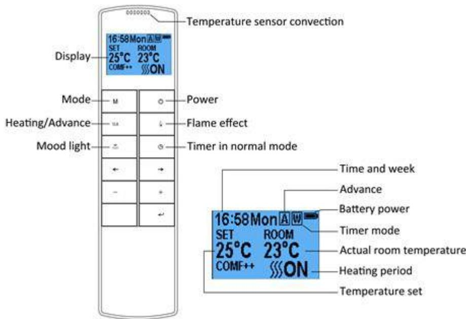
**Wichtig!** Dies ist eine Fernbedienung mit Thermostat. Die Fernbedienung sollte sich immer im selben Raum befinden, in dem sich der Kamin befindet und auf einer ebenen Fläche stehen.
