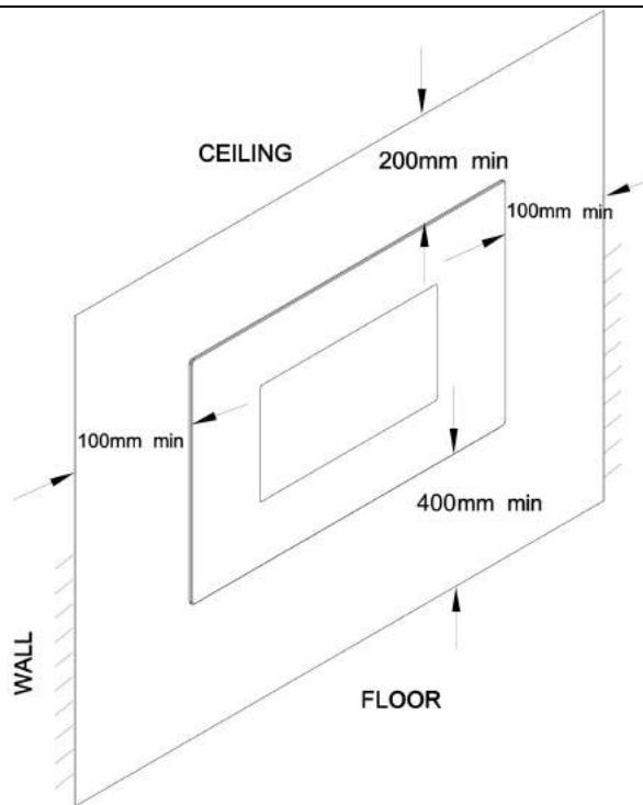
**SCHRITT 1.** Finden Sie einen sicheren Ort. Mindestabstand auf jeder Seite muss mindestens 100mm; Mindestabstand vom Boden muss mindestens 66mm; Mindestabstand von vorne muss mindestens 3 Fuß (90 cm) sein. Wählen Sie einen Ort in der Nähe einer Steckdose, so dass kein Verlängerungskabel erforderlich ist. Stellen Sie das Gerät **NICHT** direkt unter einer Steckdose.
