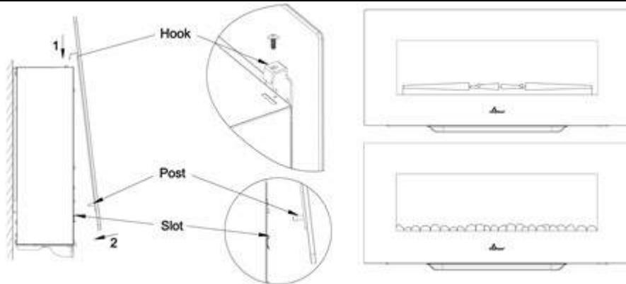
**Stap 6.** Plaatsen van de glasplaat. **Zorg ervoor dat de glasplaat goed in de gaatjes wordt geplaatst**
