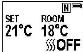
3.2.11 Appuyez sur les boutons « + » et « - » pour modifier les réglages de température. Il est préférable de choisir les températures de consigne suivantes : de 17°C à 25°C.
