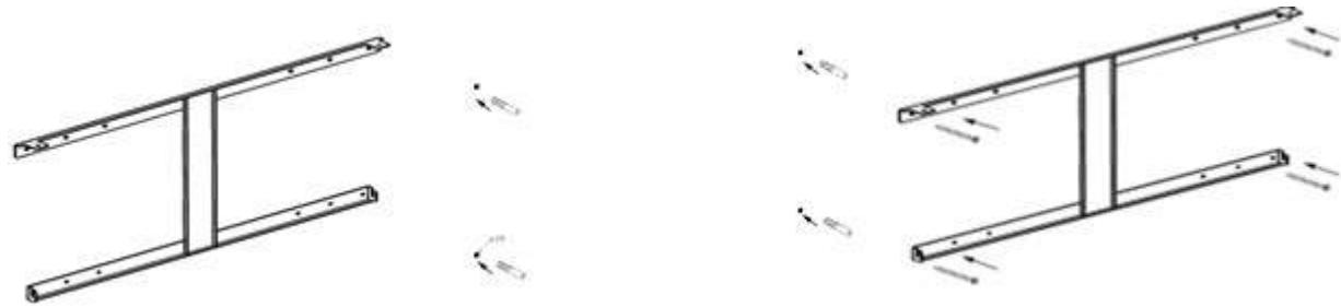
**SCHRITT 2.** Wählen Sie eine solide und einfache Wand und setzen Sie dann die Halterung an der Position, wo Sie wollen, um den Kamin zu installieren. Markieren Sie die 4 Löcher mit einem Stift aus den Löchern an der Halterung.
